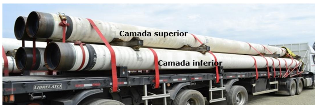
Figura 3 – Travamento horizontal e vertical da carga.
